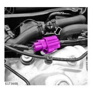
**17**Подсоедините провода JLR 418-685 и JLR 418-686 к электрическому разъему C1HF01A.
